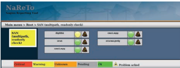
Abb. 7: Ändert einer der Hosts den Status, passt sich auch der Status des virtuellen Nodes an.
