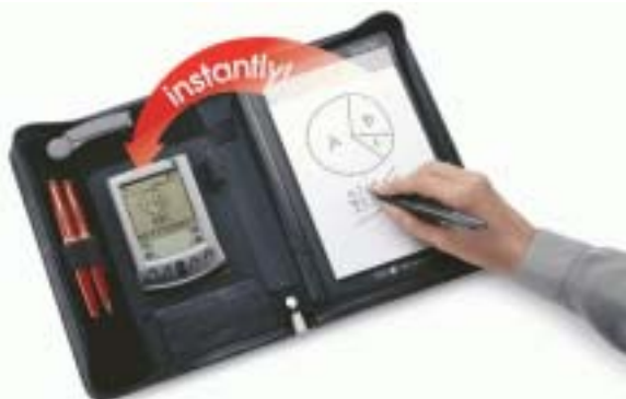
Abb. 3: Smartpad mit Block, Spezialstift und Infrarot-Übermittlung an den Palm PDA (Herstellerprospekt)
