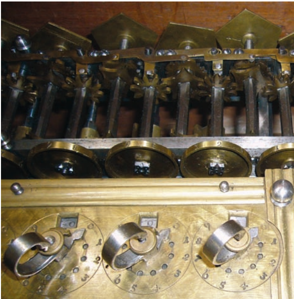
Abb. 7: Drei Einstellräder mit Schaulöchern und Teil des Ergebniswerks mit Ziffern auf dem Rand der Resultaträder 1
