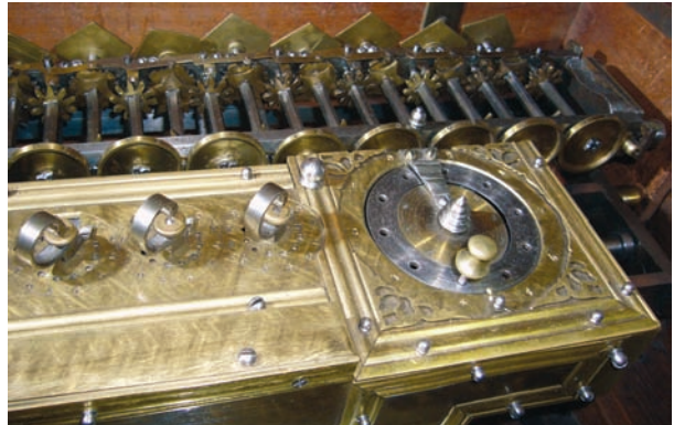
Abb. 5: Einer-, Zehner- und Hunderterstelle des Eingabewerks und Umdrehungszählwerk; im Resultatwerk sind zu erkennen die Resultaträder, die Zählräder, die Muldenräder und die Pentagon-Scheiben 3
