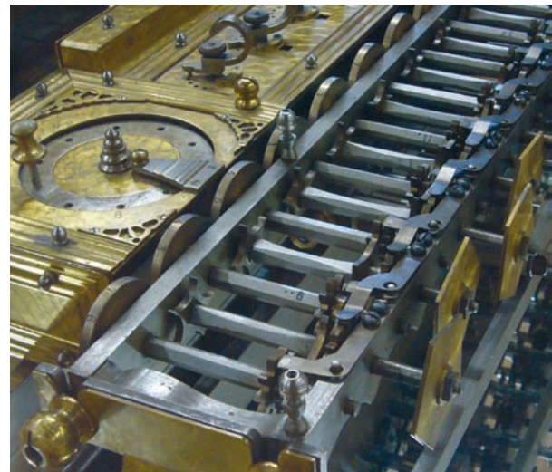
Abb. 13: Im Resultatwerk sieht man ganz links die Resultaträder, davor auf der dazwischen liegenden Vierkantwelle die Fünfhörner. Rechts sieht man die Zählräder und auf der anderen Welle die Muldenräder, die Federn zum Einrasten der Rastkerbenräder und die Pentagon-Scheiben 2
