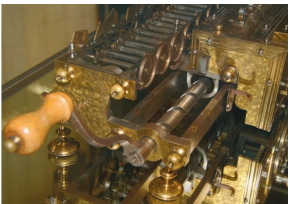
Abb. 4: Mittels Kurbel und Spindel kann das Eingabewerk am Resultatwerk entlang verschoben werden 2
