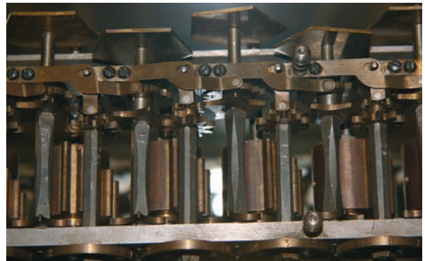
Abb. 6: Unter dem Ergebniswerk liegende Staffelwalzen; zu erkennen sind auch die Zählräder und die auf der gleichen Vierkantwelle angebrachten Resultaträder. Die auf den dazwischenliegenden Wellen mit Fünfhorn und Muldenrad angebrachten Pentagon-Scheiben dienen zur Anzeige noch nicht vollständig ausgeführter Überträge 4
