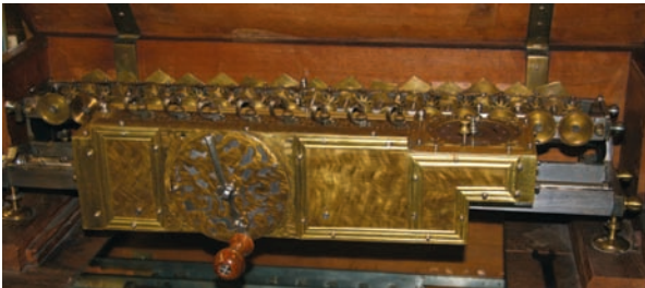
Abb. 3: Vorn der verschiebbare Schlitten mit Kurbel, achtstelligem Eingabewerk und Umdrehungszählwerk 1
