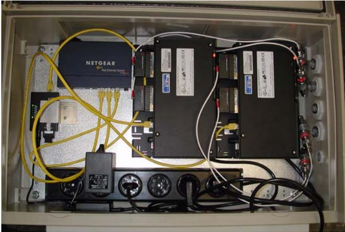
In dieser Box sind zwei APs mit jeweils vier Karten und dem Anschluss von vier externen Antennen enthalten. Darüber hinaus sind auch ein interner Ethernet-Switch, ein Glasfaser-Medienwandler, ein Blitzschutz sowie eine Steckdosenleiste enthalten.
